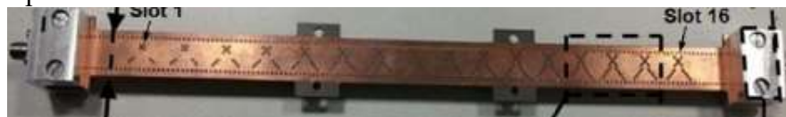
Figura 2.20. Antena de ranuras alimentada en serie.
