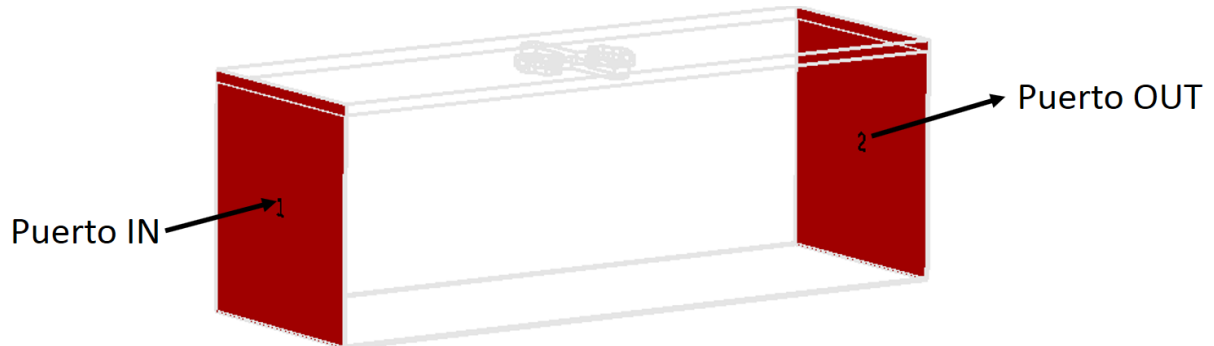
Figura 2-15 Simulación de dos puertos en CST
