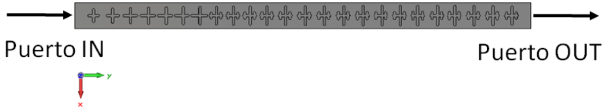
Figura 7-7 Array Construido en CST
