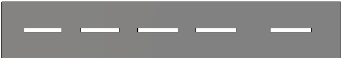
Figura 2-7 Ranuras sobre guía de onda
