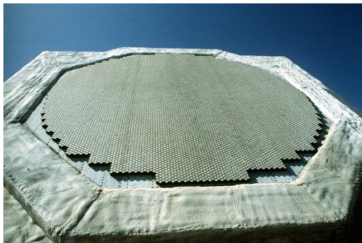
Figura 2-3: Antena phased-array para sistema de radar
