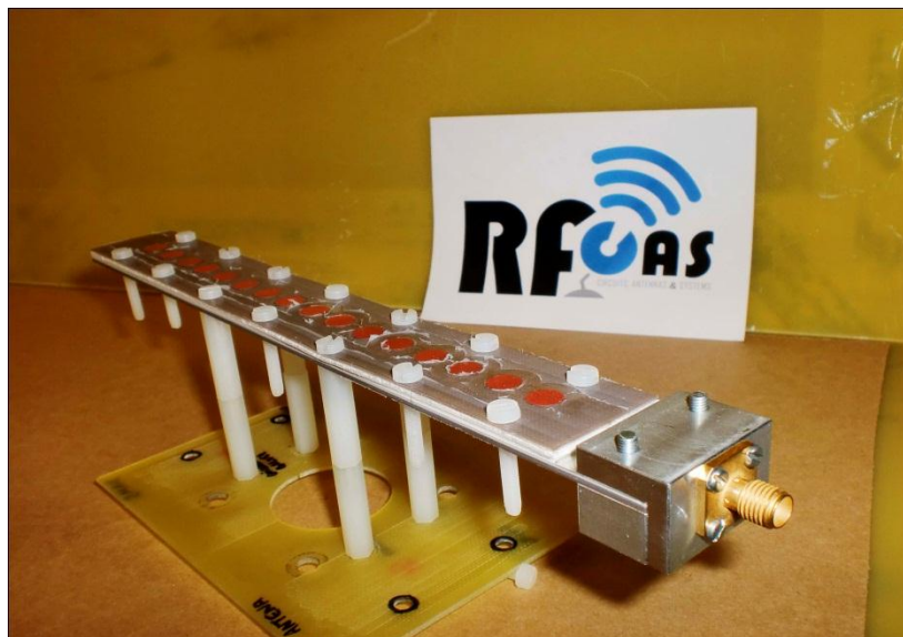
Figura 7-2: Montaje final de la antena lineal
