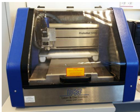
Figura A-1: Máquina de fresado LPKF ProtoMat S100
