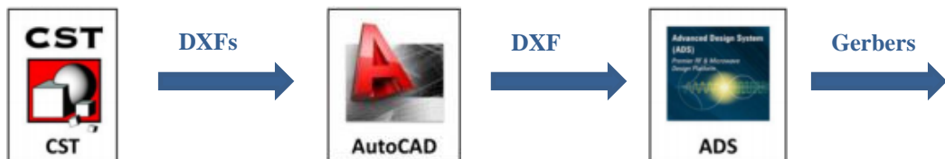
Figura A-2: Diagrama para la obtención de los gerbers
