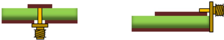
Figura 2-41: Alimentaciones microstrip por coaxial
