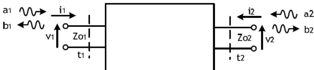
Figura 2-7: Componentes de Parámetros S en un circuito de 2 puertas
