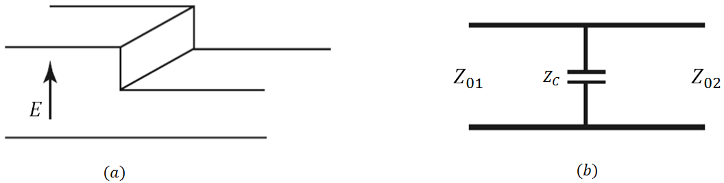
Figura 3.4 – (a) Discontinuidad de plano E y (b) su circuito equivalente, extraídos de [5]
