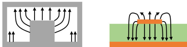
Figura 2-8: Campo eléctrico en una guía RW (izquierda) y una microstrip (derecha)
