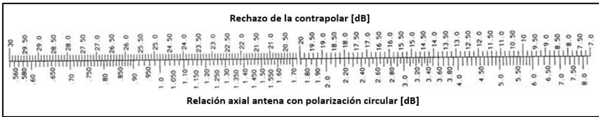
Figura 3-36: Nivel de rechazo de la componente contrapolar de una antena con polarización circular. [20]
