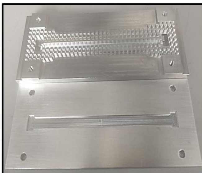
Figura 4-1: Guía RGW fabricada en aluminio.
