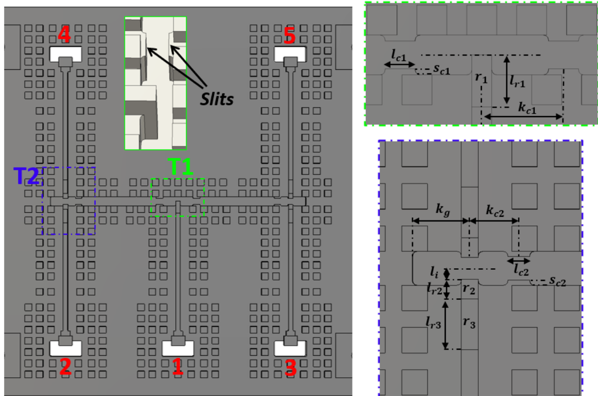
Figura 3-14: Placa inferior del divisor de potencia H, con detalle de las discontinuidades T y sus dimensiones.
