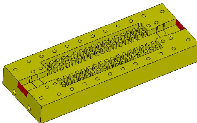
**Figura 4.1.** GGW preparada para su construcción.
