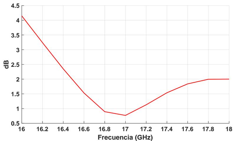
**Figura 3.54. Axial Ratio en broadside de la antena con la red de alimentación en GW.**
