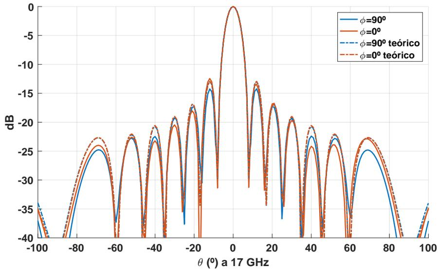
**Figura 3.53. Comparación diagrama de radiación teórico y simulado a 17 GHz con la red de alimentación en GW.**
