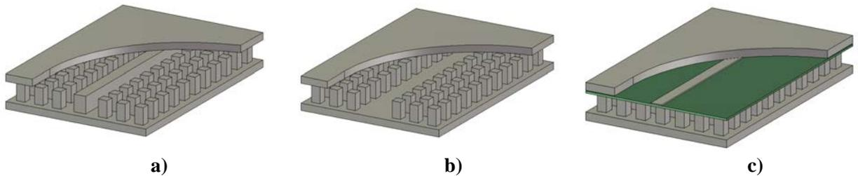
Figura 2.13. Diferentes tipos de guías estructuradas basadas en camas de pines: a) RGW, b) GGW y c) MGW.
