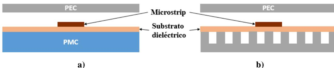
Figura 2.16. Estructura de una Microstrip Gap Waveguide a) ideal y b) con estructura EBG.
