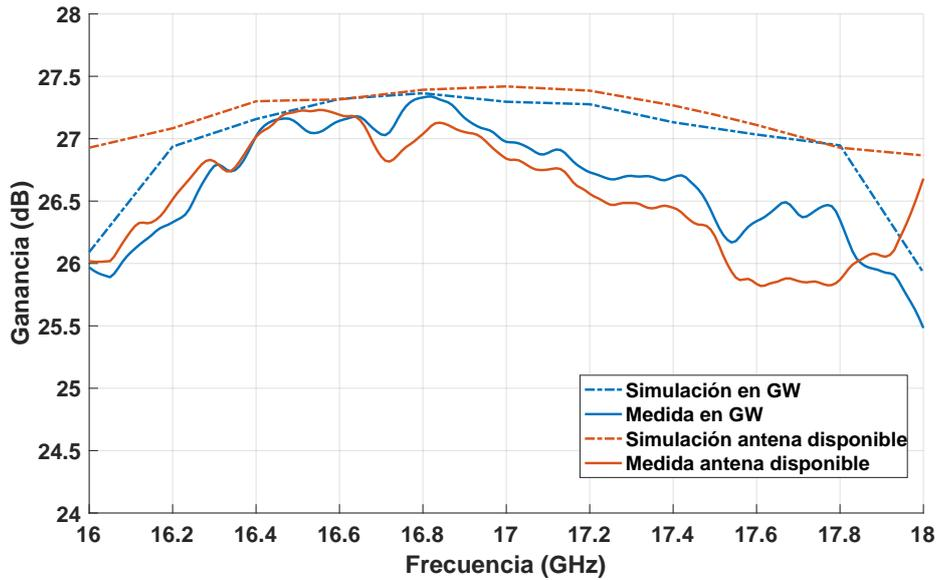
**Figura 4.13. Comparación de la ganancia de simulación y medida de la antenna disponible con la nueva antenna.**
