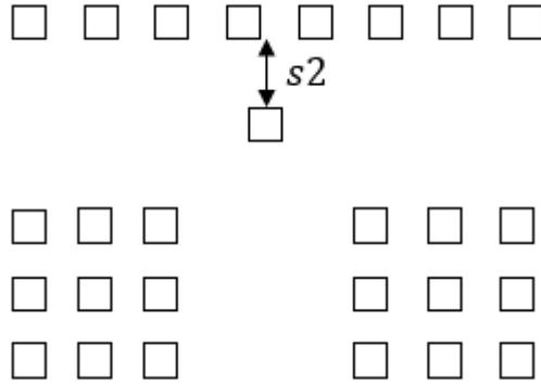
Figura 3.19. Divisor de potencia en T con un pin en la bifurcación como discontinuidad.
