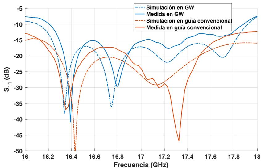
Figura 4.12. Comparación de adaptación de simulación y medida de la antena disponible con la nueva antena.
