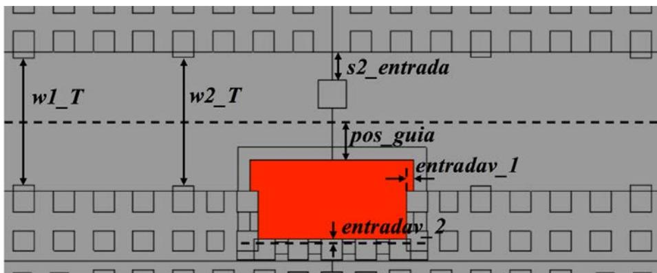
**Figura 3.34. Vista superior de la sección de entrada de la WR-51 a la antena.**
