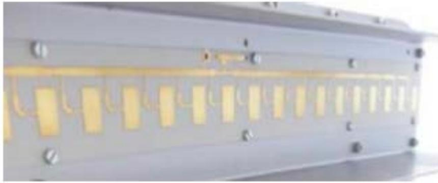
**Figura 2.6. Red de alimentación con configuración serie.**
