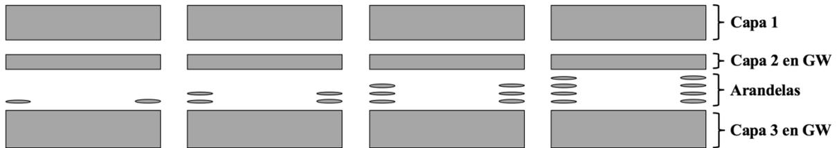
Figura 4.19. Una, dos, tres y cuatro arandelas entre las capas 2 y 3.
