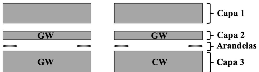
Figura 4.21. Una arandela entre las capas 2 y 3.
