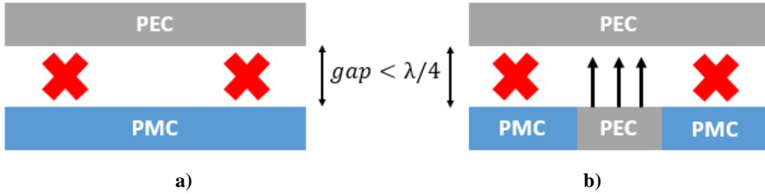
**Figura 2.10. Principio de funcionamiento de las guías GW.**
