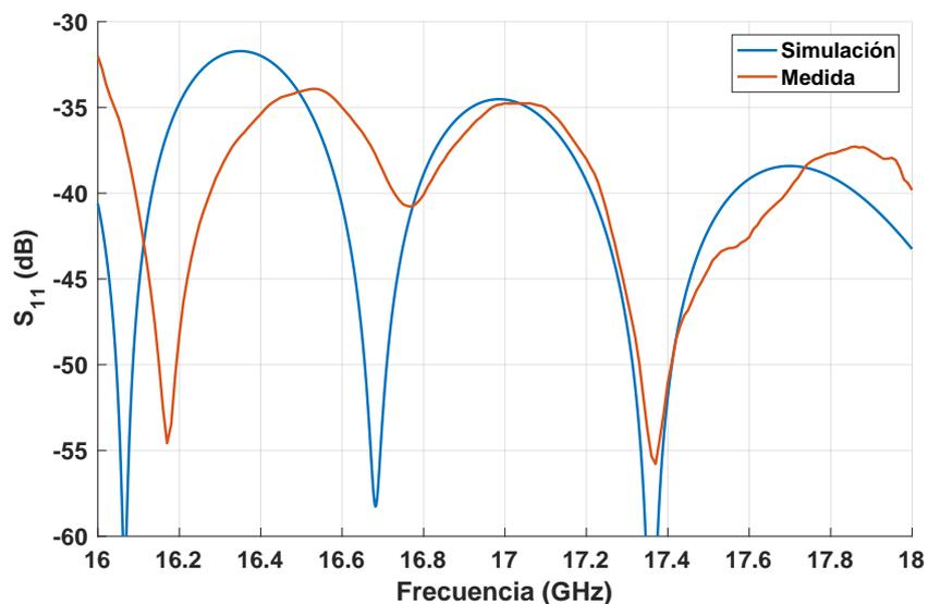
**Figura 4.4. Comparación de la adaptación simulada con la medida de la GGW.**
