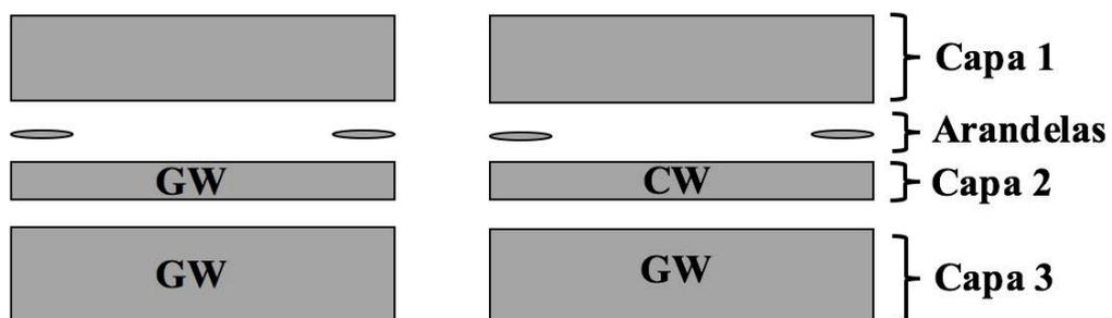
Figura 4.23. Una arandela entre las capas 1 y 2.
