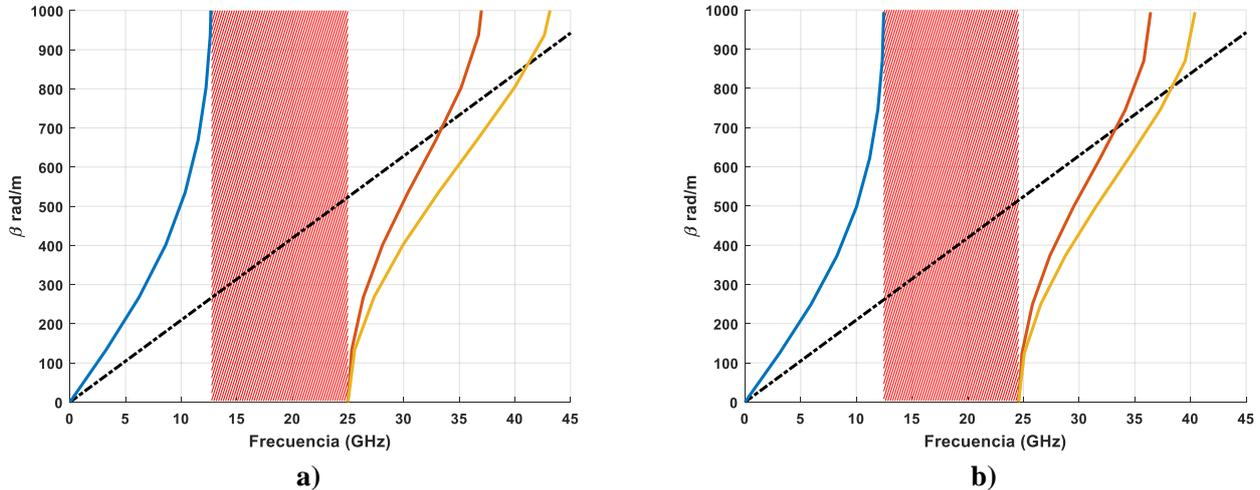
Figura 3.18. Rediseño de pines para las zonas más estrechas de la red. Zonas de a) 4.37 mm de ancho y b) de 4.82 mm de ancho.
