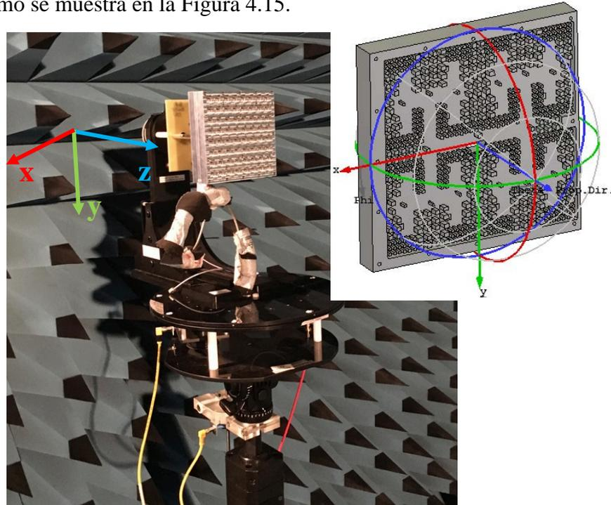
**Figura 4.15. Antena construida en la cámara anecoica.**
