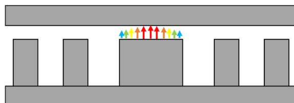
Figura 2.14. Estructura de una Ridge Gap Waveguide (RGW).
