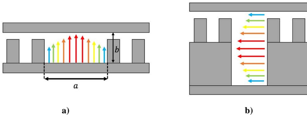
Figura 2.15. Groove Gap Waveguide con a) polarización vertical y b) polarización horizontal.
