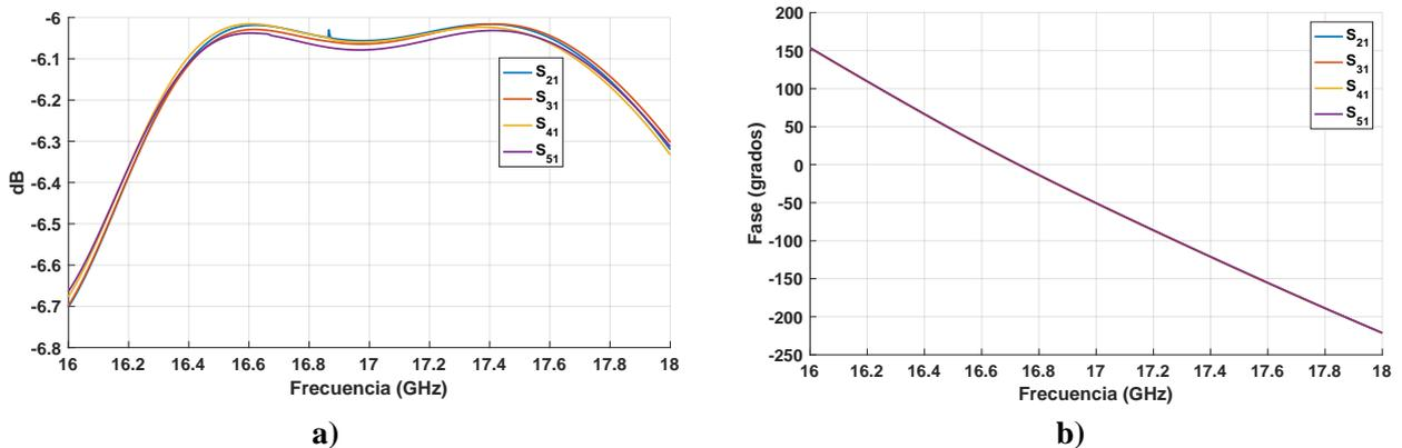
Figura 3.36. a) Reparto de potencia y b) diferencia de fase simulados en la entrada en transición vertical.
