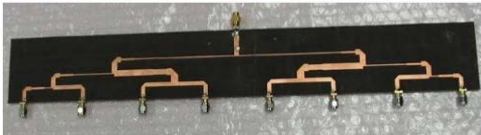
**Figura 2.7. Red de alimentación con configuración paralelo.**
