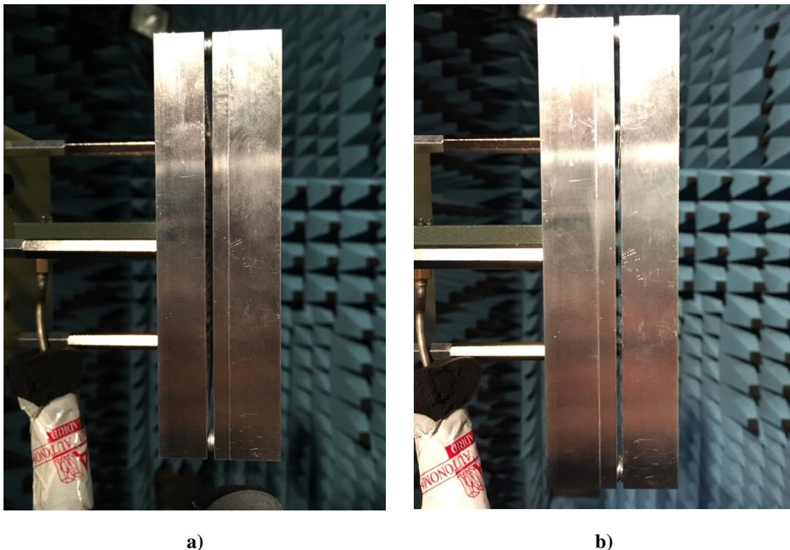
**Figura 4.18. Medida de la antenna completa con arandelas separando a) las capas 2 y 3 y b) las capas 1 y 2.**
