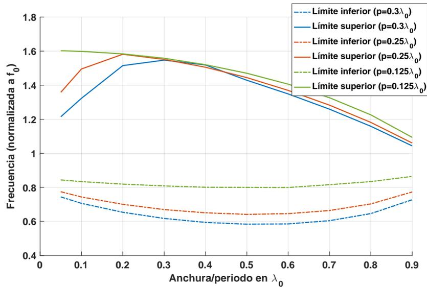
Figura 3.8. Límites superior e inferior de la stopband en función del ratio entre el ancho del pin,  $w$ , y el periodo,  $p$ , en  $\lambda_0$ , con un gap de  $0.04\lambda_0$ , para diferentes periodos  $p$  y una anchura de pin  $w$  variable, con la frecuencia normalizada a  $f_0 = 17 \text{ GHz}$ .
