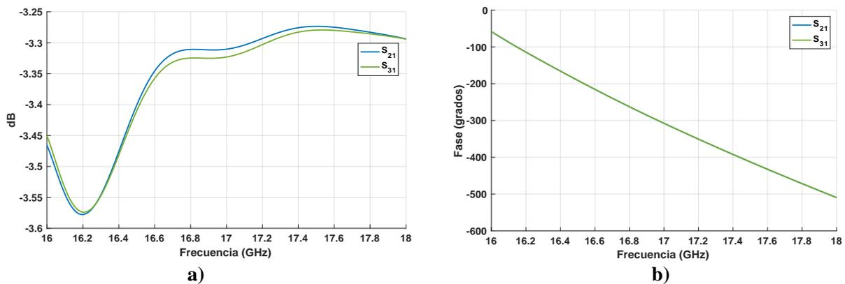
**Figura 3.30. a) Reparto de potencia y b) diferencia de fase simuladas del divisor de potencia en T.**
